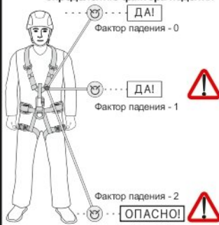
Рис. 7. Графическая схема к определению фактора падения
