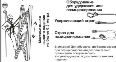
Рис. 10. Позиционирование в рабочем положении
