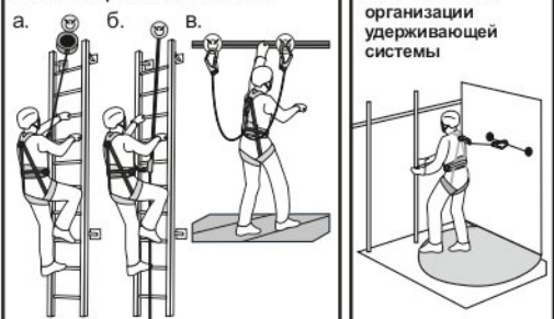
Рис. 13. Пример организации системы канатного доступа
